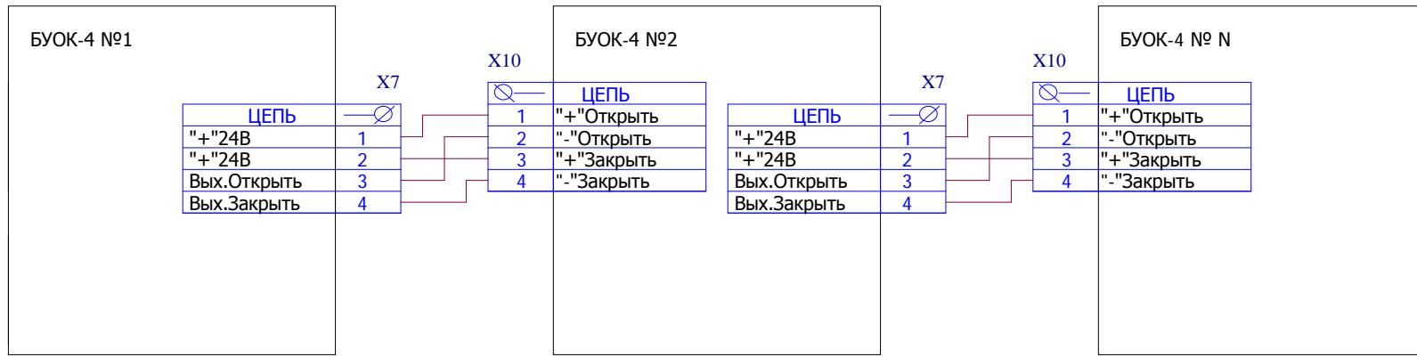
**Рис. 12. Схема соединения блоков БУОК в группу**
